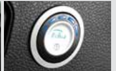
LPG 스위치 LPG 충전량 표시 및 LPG와 가솔린 전환
