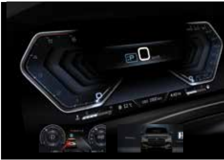
12.3인치 풀 디지털 클러스터 (주행안전 보조시스템 표시, Welcome & Goodbye 모드)
