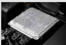
LPG ECU LPG전용 ECU로서 가솔린 ECU와 협업하여 2개 연료를 최적화
